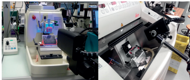
Figure 1 : Installation de la caméra KIS face aux microtome (A) et cryostat (B) grâce à un bras amovible fixé à la paillasse par une noix de serrage.
