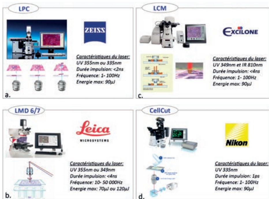
Figure 4 : Principe et caractéristiques des différents systèmes de microdissection laser vendus en France.
