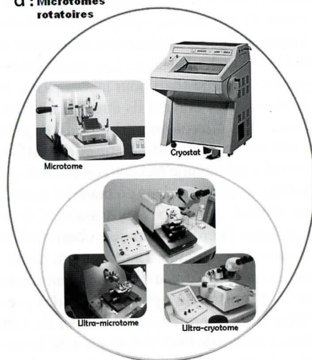
Figures 2 : L'ensemble des microtomes peuvent être regroupés en trois grandes familles selon leur type de mécanisme : a- les microtomes rotatoires, b- les microtomes à glissière et c- les vibratomes et Tissue Chopper
